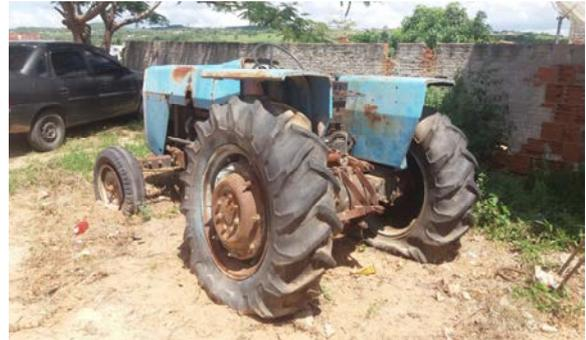
**SITUAÇÃO DA MÁQUINA:** MOTOR RUIM, CAIXA DE MARCHA REGULAR, LATARIA AVARIADA E INCOMPLETA, PNEUS E RODAS DESGASTADOS E INCOMPLETOS.
